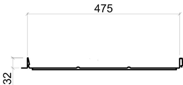
Поперечный разрез модели Classic D
