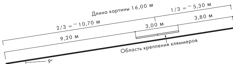
Схема 2.1: Пример односкатной кровли с уклоном 9^\circ , длина картины 16 м
